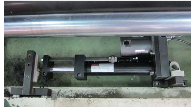
Elektrik Aktüatör AD-24 baskı makinesi sargı açma işlemi için kullanılmaktadır.
